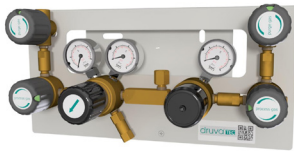
Entspannungsstation mit semiautomatischer Umschaltung zwischen zwei Hochdruckeingängen inklusive Eigengasspülung/Druckentlastung.
